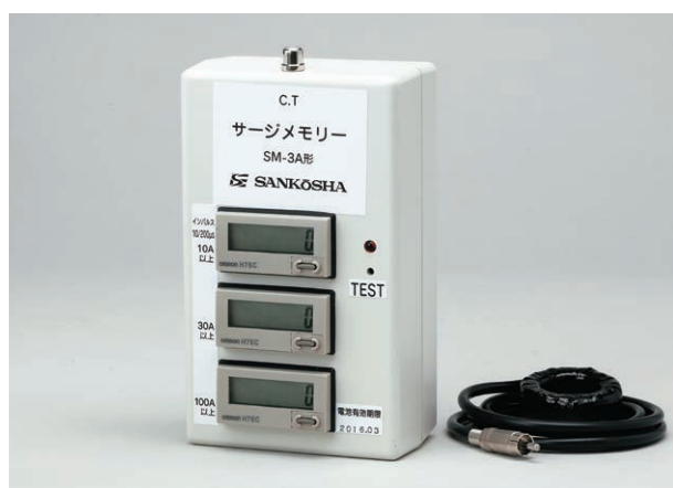
寸法：W95×D158×H60 (mm) (CT接続端子突出部除く) CT 外径 \phi 50 内径15 厚さ28
