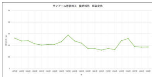
図9 サンアース帯状施工 接地抵抗 経年変化
