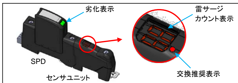
図 1. スマート SPD SPD とセンサユニットは一体的に取付け可能。
