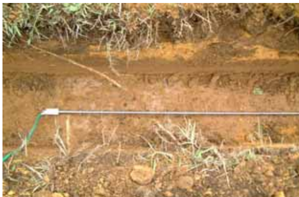
羽根付アースと針タイプ棒の 定常接地抵抗と過渡接地抵抗（サージインピーダンス）
